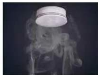
▲ Czujnik dymu wykorzystujący izotop promieniotwórczy
